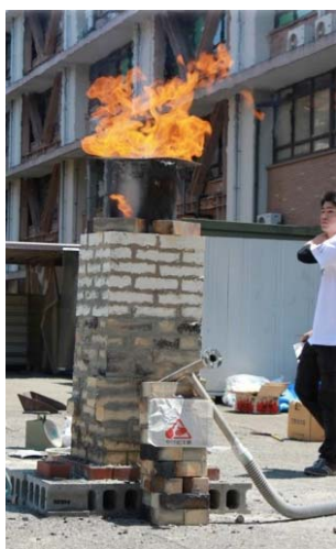
五月祭でのたたら製鉄実演風景
