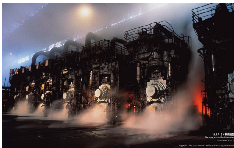
製鉄所の熱間圧延工程 (写真提供：(一社)日本鉄鋼連盟)
